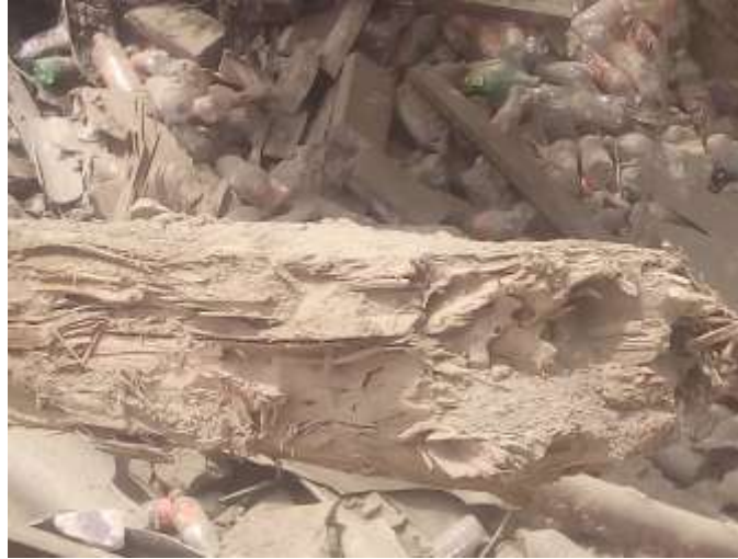
Fig. 4. Viga podrida y basura en el fondo
